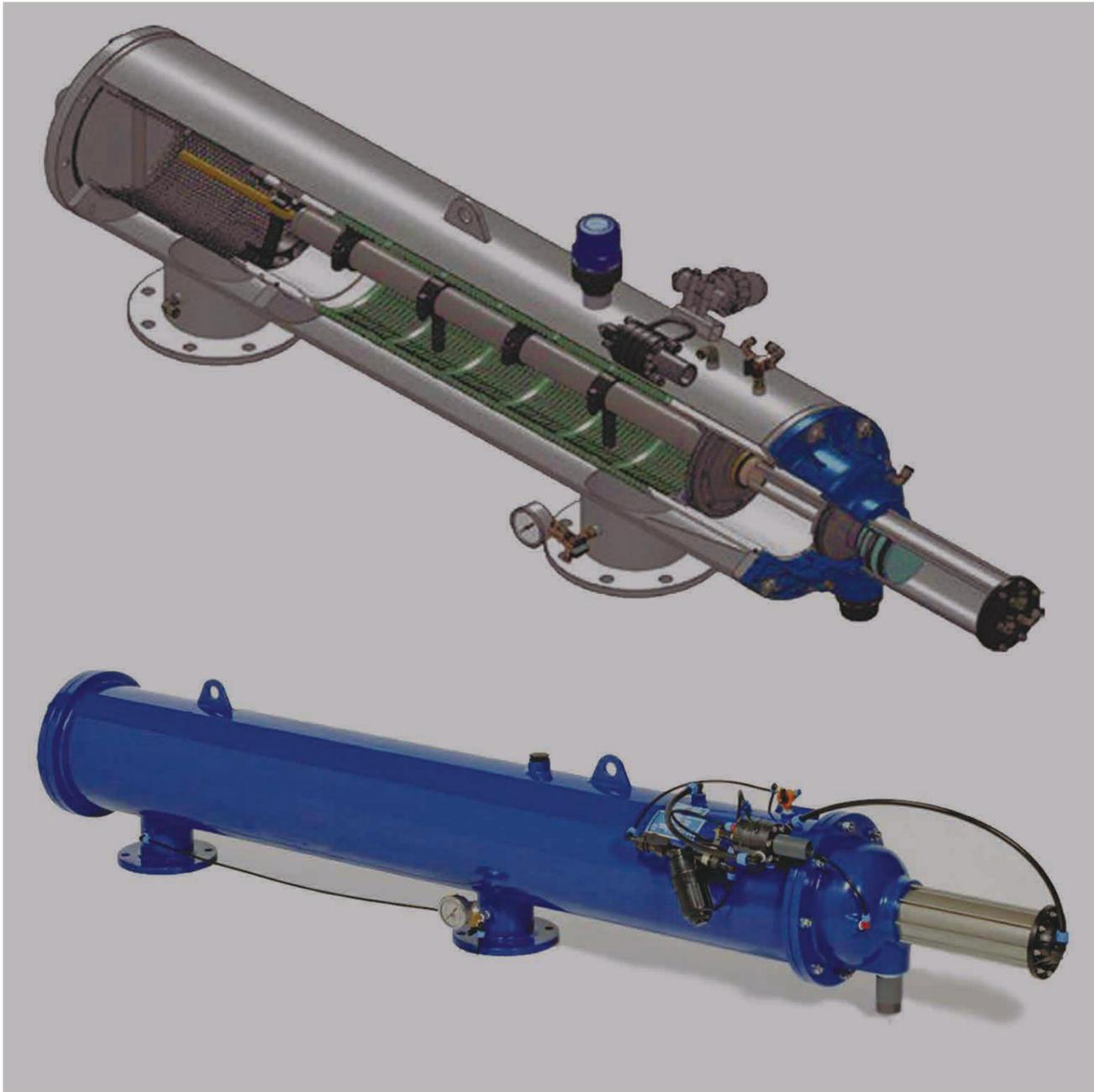
چرخه فعالیت فیلتر خودشوینده، جهت تمیز کردن فیلتر مشابه جاروبرقی می باشد. نازل ساکشن (نازل مکنده) مواد جامد را از روی صفحه اسکرین به صورت چرخشی و ماریپیچ تمیز می کند تا تمیز کردن کل صفحه به خوبی انجام شود.
